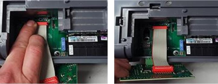
Die Interface Platine wird in durch drei Plastikklammern des Gehäuses festgehalten.
