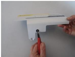
Einsetzen der Gummi-Kabeltülle
