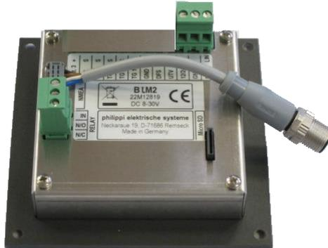
Damit werden die Batteriespannungen über die PGNs 127751 (DC Voltage Current) und PGN 127506 (DC Detailed Status) in das NMEA2000 Netzwerk gesendet, sobald der Monitor in Betrieb geht.
